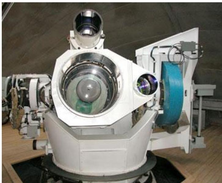
Телескоп траекторных измерений (ТТИ) в укрытии
